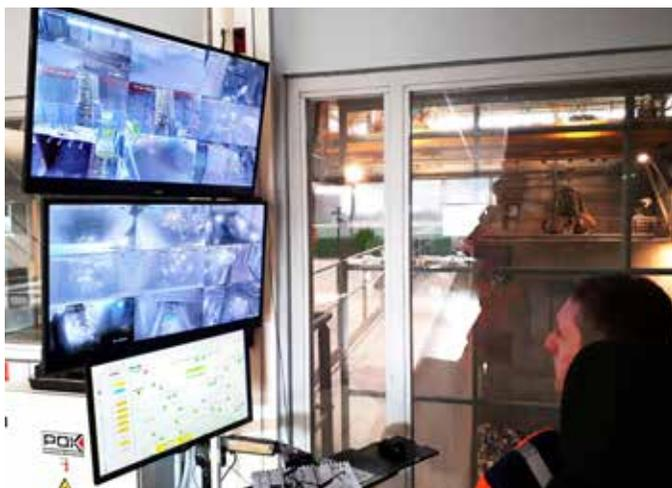
Poste de pontier équipé d'un mur d'image
